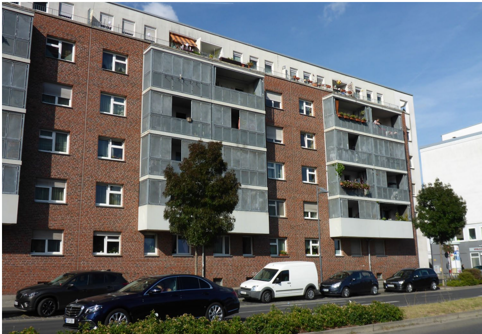
Abb. 6: Balkone mit verschiebbaren Schutzelementen. Damit ist kein TA-Lärm-konformer Schutz vor Gewerbelärm möglich
